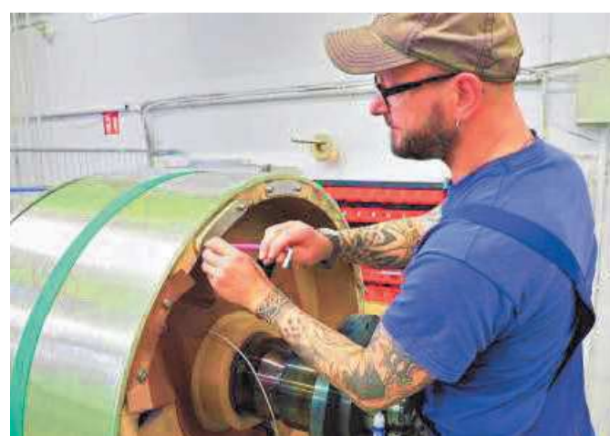
Jörn Müller schraubt beim Auswuchten kleine Gewichte an den Rotor, damit der Motor später rund läuft.
