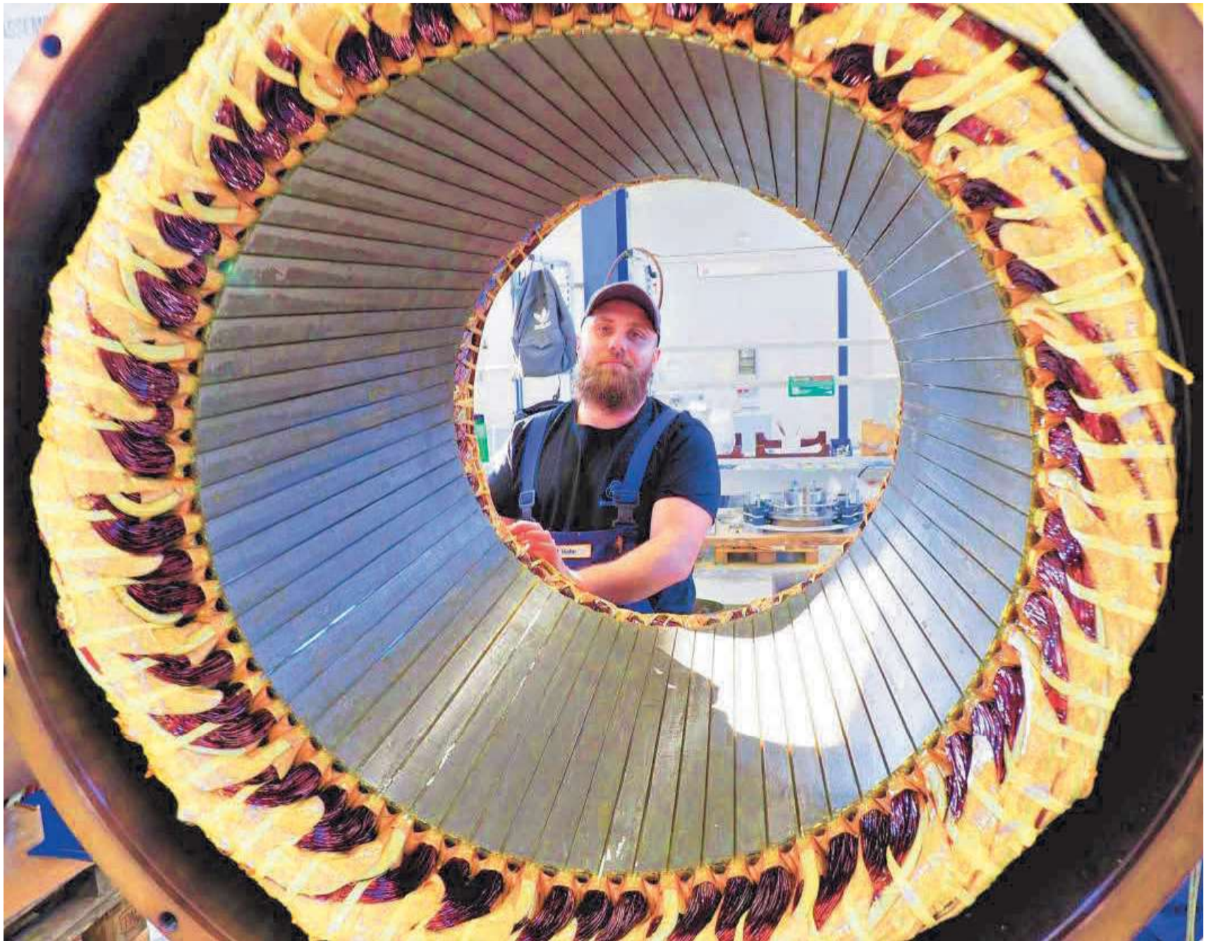
Nach einer Woche Arbeit sind die Wicklungen in den Stator eingefädelt und verankert. Marcel Hahn bei den letzten Handgriffen.
