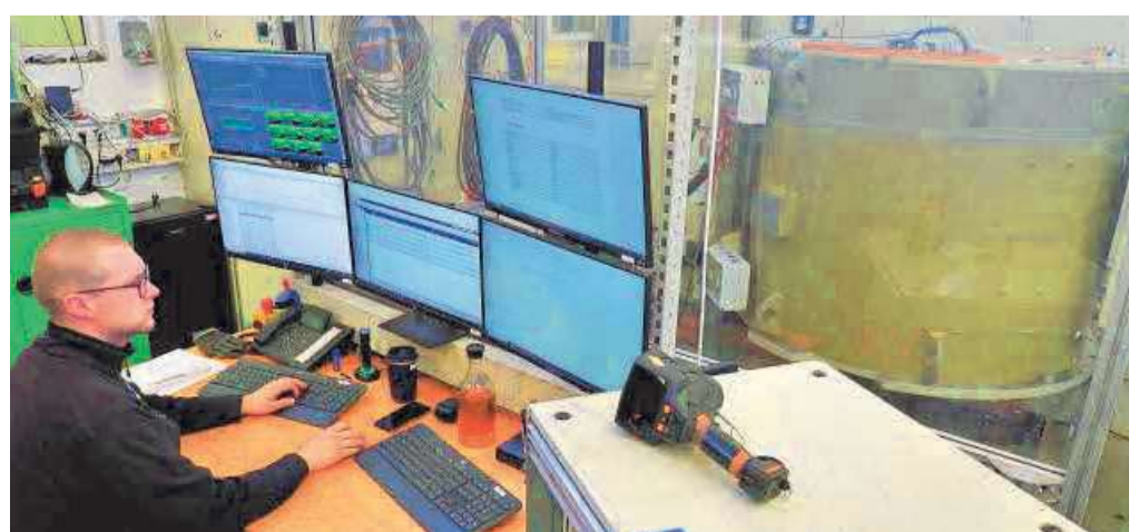
Daniel Kaufmann überwacht an Bildschirmen die Parameter eines Elektromotors, der zunächst intern sowie danach im Beisein eines externen Prüfers und des Abnehmer insgesamt zwei Tage lang für das Auslieferungszertifikat getestet wird.
